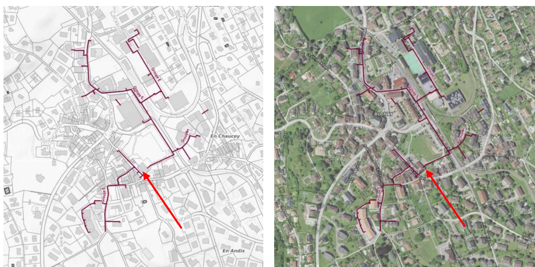
Figure 13 : Tracé du réseau CAD. La flèche indique l'emplacement de la centrale de chauffe.
